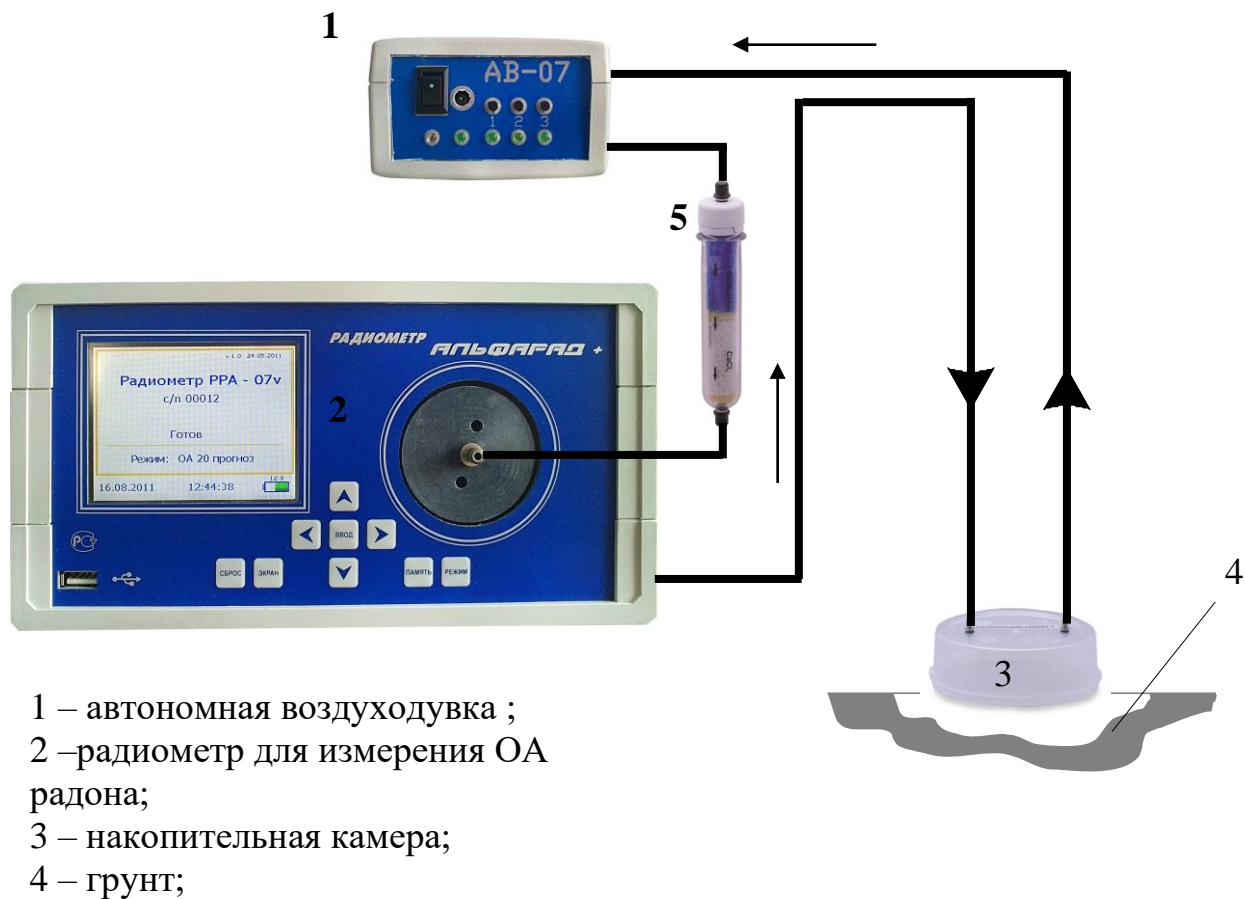
Рисунок 2.2. Схема 2 отбора пробы воздуха для определения ППР.
